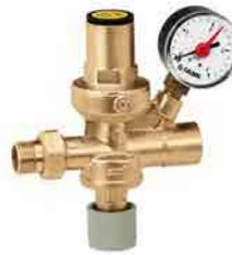
Gruppo di riempimento automatico, con rubinetto, filtro, valvola di non ritorno. Campo di regolazione: 0,3-4 bar. Pmax in entrata: 16 bar. Tmax d esercizio: 70 °C.
