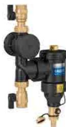
Defangatore e filtro. Specifico per PDC Defangatore con elemento interno in tecnopolimero, completo di magnete. Due filtri ispezionabili con maglia in acciaio: 1 di primo passaggio (di colore blu) già installato, 1 di mantenimento (di colore grigio) in confezione. Valvole
