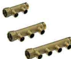
Collettore semplice M.F. componibile uscite laterali Maschio da 1/2 sede conica da 1/2, interasse fra le uscite 37,5 mm
