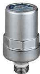
Ammortizzatore del colpo d'ariete. Corpo in ottone. Cromato. Pmax d'esercizio: 10 bar. Tmax d'esercizio: 90 °C. Filetto a tenuta PTFE.
