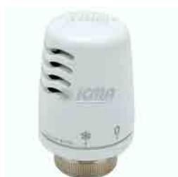
Testa termostatica per valvole termostattizzabili. Elemento sensibile a liquido. Sistema di limitazione e bloccaggio della temperatura tramite forcina di limitazione. Isteresi 0,19K; Campo di regolazione temperatura ambiente T = 7-28°C
