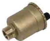
Valvola automatica di sfogo aria a galleggiante Pressione max 10 bar pressione di scarico aria 6 bar temperatura massima di esercizio 110 °C .
