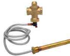
Valvola di scarico termico a doppia sicurezza a raggiungimento della temperatura di 95°C la valvola si apre permettendo l'uscita d'acqua calda in eccesso. Temperatura d'apertura 95°C, capacità max: 93 KW 80000 Kcal/h.
