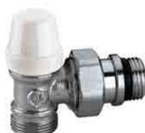
Detentore, attacchi a squadra, per tubi in rame, plastica semplice e multistrato Cromato. Attacchi a squadra, per tubi in rame, plastica semplice e multistrato. Pmax d'esercizio: 10 bar. Campo di temperatura: 5-100 °C.
