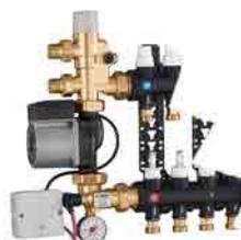
Gruppo di regolazione a punto fisso preassemblato, Completo di: gruppo di regolazione a punto fisso termostatico, termostato di sicurezza, pompa ad alta efficienza. Pmax d esercizio: 10 bar. Campo di temperatura di regolazione: 25-55 °C. Alimentazione: 230 V - 50/60 Hz.
