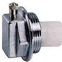
Tappo per radiatore con valvola di sfogo aria automatica a galleggiante. Guarnizione a fondo filetto in EPDM. Pressione max di esercizio: 10 bar Temperatura max :110 °C
