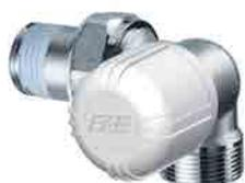
Valvola termostattizzabile ad angolo SINISTRO. Attacco per tubo rame, plastica e multistrato. Semplice sistema di estrazione volantino. Perno inox con doppio O-Ring di tenuta. Molla di richiamo rinforzata e otturatore piatto. Codolo preguarnito
