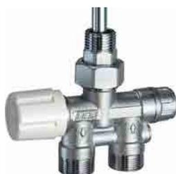
Valvola MONO-BITUBO termostaticabile diritta, completa di codolo e calotta. Sonda metallica 450mm Ø 10mm. Attacchi per tubo rame, plastica e multistrato. Attacco centrale al corpo scaldante. Interasse derivazioni 35mm
