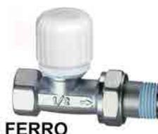
Valvola termostattizzabile diritta cromata. Attacco per tubo FERRO. Semplice sistema di estrazione volantino. Perno inox con doppio O-Ring di tenuta. Molla di richiamo rinforzata e otturatore piatto. Codolo preguarnito.
