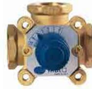
Valvola miscelatrice deviatrica per impianti centralizzati di riscaldamento evita la condensazione dei vapori all'interno del generatore. La miscelazione, dell'acqua di mandata e di quella di ritorno, è assicurata dal profilo delle vie sagomate, angolo di rotazione circa 90°,
