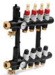
Collettore Tempower modulare ; con valvole di intercettazione motorizzabili sul ritorno e misuratori di portata da 0-8 l/m in sulla mandata; con di rubinetti di carico/scarico, valvole di sfiato automatiche, termometri, staffe di supporto. Attacchi collettore del diametro di 1" F.
