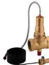
Valvola di intercettazione del combustibile. orpo in ottone. Pmax d esercizio: 50 kPa. Lunghezza capillare: 5 o 10 m. Certificata e tarata a banco INAIL (Ex ISPESL): tarature 98 °C e 110 °C. Certificata e fornita di verbale di taratura a banco del fabbricante: taratura 120 °C.
