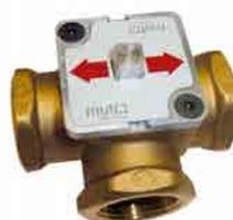
Valvola miscelatrice per sistemi con generatore termico alimentato a combustibile solido abbinato a serbatoio di accumulo per garantire il ritorno di acqua sufficientemente calda alla caldaia, per garantire un regime termico di funzionamento elevato da
