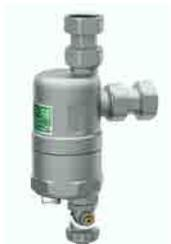
Defangatore COMPACTFAR a squadra completo di magnete. Corpo in ottone attacchi F-F Rubinetto di scarico evacuazione fanghi Pressione nominale: 10 bar Temp. massima di esercizio: 110°C magnete estraibile.
