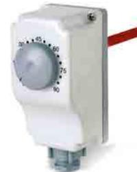
Termostato regolabile è impiegato su impianti di riscaldamento per la regolazione di pompe, bruciatori, aerotermi ecc. L'elemento sensibile del termostato è direttamente inserito nel pozzetto immerso nel liquido. Temperatura compresa tra 20 e 90 °C.
