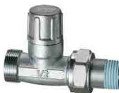
Detentore diritto cromato. Attacco per tubo rame, plastica e multistrato. Cappuccio in ottone. Doppio O-ring di tenuta sull'asta Otturatore a battuta metallica e tenuta con O-ring. Codolo preguarnito.
