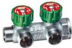
Collettore componibile MULTIFAR per impianti sanitari o riscaldamento con arresti manuali, dotati di volantino con due dischetti serigrafati per identificare l'utenza di ogni singola derivazione. Attacchi per tubo rame, plastica e multistrato. Derivazioni: 45mm
