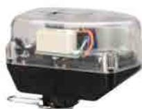
Servomotore per valvole di zona a sfera, normalmente chiuso, con relè e microinterruttore ausiliario. T max.ambiente 55°C, grado di protezione IP44. Tempo apertura 45 secondi.
