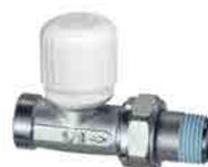
Valvola termostattizzabile diritta cromata. Attacco per tubo rame, plastica e multistrato. Semplice sistema di estrazione volantino. Perno inox con doppio O-Ring di tenuta. Molla di richiamo rinforzata e otturatore piatto. Codolo preguarnito.
