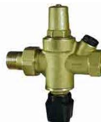
Gruppo di riempimento con rubinetto intercettazione e filtro. Attacco manometro da 1/4 su due lati. Completo di valvola di ritegno. Pressione max a monte 16 bar, pressione a valle regolabile da 1 a 6 bar, pressione di taratura a valle impostata 1,5 bar, temperatura max d'esercizio 90°C.
