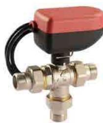
Valvola di zona a sfera con attuatore a sgancio rapido ,versione a 3 vie a 230 Volt (24 volt su richiesta) con fine corsa completa di contatto ausiliario pulito regolazione a 3 punti (spdt) o on/off (spst)
