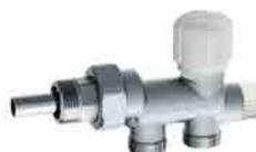
Valvola MONOTUBO termostaticabile. Attacchi per tubo rame, plastica e multistrato. Sonda metallica 450mm Ø 12mm. Interasse derivazioni 35 mm
