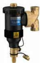
Defangatore DIRTMAG®, durante i ripetuti passaggi del fluido, è in grado di rimuovere efficacemente anche le particelle di impurità più piccole a fronte di perdite di carico molto basse. Inoltre la presenza della fascia magnetica garantisce un'elevata capacità di cattura.
