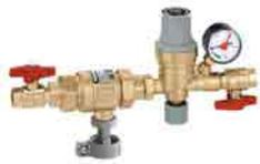
Gruppo di caricamento automatico con disconnettore tipo CAa e valvole di intercettazione. Campo di regolazione del gruppo di riempimento: 0,2-4 bar. Pmax d esercizio: 10 bar. Tmax d esercizio: 65 °C. Disconnettore certificato a norma EN 14367.
