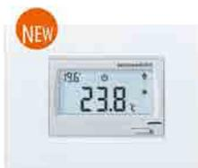
Termostato touch da incasso. Display LCD TOUCH. Alimentazione 2 pile stilo AA alcaline da 1,5 V. Autonomia 1 anno. Campo regolazione temperatura: +2/+35°C. Portata contatti: 8 (5) A 250 Vac. Funzione comfort e notturna. Modalità riscaldamento / raffrescamento.
