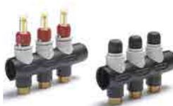
Collettore modulare TERMOPOWER 3 vie in materiale composito; completo su ogni circuito di valvole di intercettazione motorizzabili sul ritorno e misuratori di portata da 4 o 6 l/m in sulla mandata
