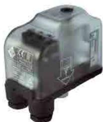
Pressostato di sicurezza omologato PED per impianti riscaldamento, arresta automaticamente il generatore di calore al raggiungimento di un limite impostato di pressione. Il ripristino tramite tasto di reset dopo che la pressione è rientrata di almeno 0,4 bar entro il valore
