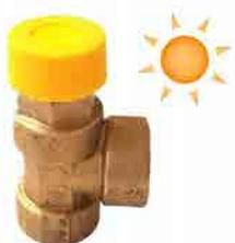
Valvola di sicurezza a taratura fissa 3-6 bar con scarico maggiorato per solare attacchi femmina, temperatura massima d'esercizio a 160°. Prodotto conforme alla direttiva Ped. 2014/68/UE categoria IV D.M.1.12.75, D.Lgs.25.02.2000. Omologazione CE n. 0425.
