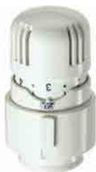
Comando termostatico con sensore a liquido incorporato. Campo di regolazione della temperatura: da 7°C a 28°C. Provvisto di un selettore numerato da 1 a 5, ruotando il quale è possibile impostare il livello di temperatura desiderato.
