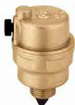
Valvola automatica di sfogo aria. In ottone stampato. Pmax d esercizio: 10 bar. Pmax di scarico: 4 bar Tmax d esercizio: 115 °C.
