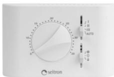
Termostato elettronico, selettore raffreddamento/off/riscaldamento selettore per il controllo manuale o automatico delle tre velocità del motore. Possibilità di configurazione funzionamento due/quattro tubi, attivazione della funzione antistratificazione.
