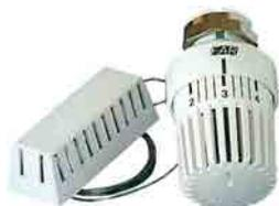
Comando termostatico con sensore a liquido. Sensore a distanza. Capillare 2 m. Campo di regolazione della temperatura: da 7°C a 28°C. Provvisto di un selettore numerato da 1 a 5, ruotando il quale è possibile impostare il livello di temperatura desiderato.
