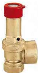
Valvola di sicurezza certificata, INAIL (Ex ISPESL). Attacchi femmina. Sovrappressione di apertura 10%. Scarto di chiusura 20 %. PN10. Campo di temperatura: 5-110°C. Tarature standard: 2,25-2,5 2,7-3-3,5-4-4,5-5-5,4-6 bar.-
