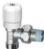
Valvola manuale ad angolo. Attacco per tubo rame, plastica e multistrato. Volantino rinforzato in metallo. Asta con doppia tenuta, O-ring e premistoppa. Otturatore a battuta metallica e tenuta con O-ring. Codolo preguarnito.
