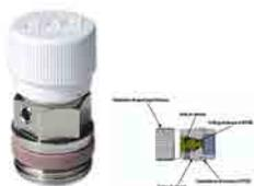
Valvola sfogo aria manuale. Volantino in plastica. Tenuta sull'asta con O-Ring. Guarnizione in PTFE per alte temperature Pressione nominale: 10 bar. Temperatura massima d'esercizio: 95°C
