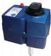
Motore V200 On/Off 3 punti per valvole serie 1000 e 2000 - Corsa 90° in 220 sec. (su richiesta 125/540 sec.) - Completo di micro ausiliario
