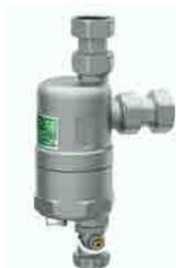
Defangatore COMPACTFAR a squadra completo di magneti. Corpo in ottone attacchi F-F Rubinetto di scarico evacuazione fanghi Pressione nominale: 10 bar Temp. massima di esercizio: 110°C magneti estraibili.
