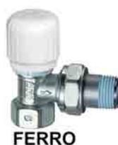
Valvola termostattizzabile a squadra cromata. Attacco per tubo ferro. Semplice sistema di estrazione volantino. Perno inox con doppio O-Ring di tenuta. Molla di richiamo rinforzata e otturatore piatto. Codolo preguarnito.
