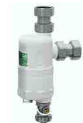
Defangatore bianco con attacchi a squadra completo di magneti per l'eliminazione delle particelle ferrose. Corpo in ottone attacchi F-F Rubinetto di scarico evacuazione fanghi Pressione nominale: 10 bar Temp. massima di esercizio: 110°C magneti estraibili.
