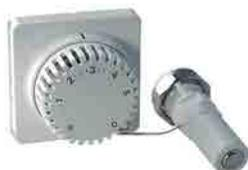
Comando termostatico con sensore a liquido. Selettore a distanza. Capillare 2 m. Campo di regolazione della temperatura: da 7°C a 28°C. Provvisto di un selettore numerato da 1 a 5, ruotando il quale è possibile impostare il livello di temperatura desiderato.
