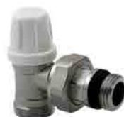
Detentore ad angolo per tubo di rame, Multistrato, Pe-X. Doppia tenuta sulla sede, o-ring più tenuta metallica. Corredato di bocchettone antigocciolamento. Senza adattatore
