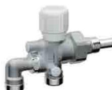
Valvola MONO-BITUBO termostaticabile diritta cromata con interasse variabile. Attacchi intercambiabili per tubo rame, plastica e multistrato. Sonda metallica 450 mm Ø 12 mm. Interasse derivazioni 40-50 mm
