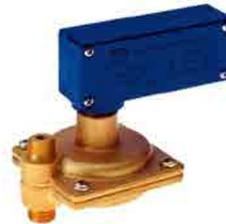
Pressostato differenziale SFS chiude, o devia, un contatto elettrico quando il differenziale di pressione applicato alle due prese raggiunge il valore di taratura superiore (intervento) e lo ripristina quando essa scende sotto il valore di taratura inferiore (rilascio).
