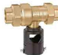
Disconnettore a zone di pressioni differenti non controllabili. Tipo CA. Corpo in ottone PN10. Attacchi a bocchettone. Tmax d esercizio: 65 °C. Certificato a norma EN 14367.
