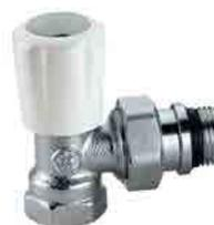
Valvola termostaticabile, attacchi a squadra, per tubo in ferro, per comandi termostatici, elettrotermici, elettronici. Cromata. Attacchi a squadra, per tubo in ferro. Pmax d'esercizio: 10 bar. Campo di temperatura: 5-100 °C.
