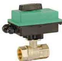
Valvola sfera motorizzata sevocontrollo ALL-IN- 2 punti con relé Grado di protezione: IP67 Tempi di manovra: 45 sec per rotazione 90° C 22Nm Tipo protetto, apertura manuale, 2 micro supplementari liberi di serie Corpo valvola 2 vie FF in OTTONE, passaggio totale PN40
