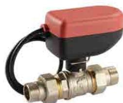
Valvola di zona a sfera con attuatore a sgancio rapido ,versione a 2 vie a 230 Volt (24 volt su richiesta) con fine corsa completa di contatto ausiliario pulito regolazione a 3 punti (spdt) o on/off (spst) diametri disponibili da ø ½ a ø 1"
