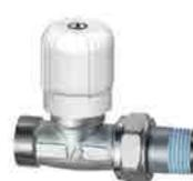
Valvola manuale diritta. Attacco per tubo rame, plastica e multistrato. Volantino rinforzato in metallo. Asta con doppia tenuta, O-ring e premistoppa. Otturatore a battuta metallica e tenuta con O-ring. Codolo preguarnito
