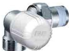
Valvola termostattizzabile angolo DESTRO. Attacco per tubo rame, plastica e multistrato. Semplice sistema di estrazione volantino. Perno inox con doppio O-Ring di tenuta. Molla di richiamo rinforzata e otturatore piatto. Codolo preguarnito.
