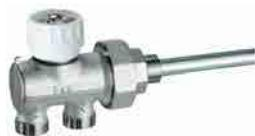
Valvola MONOSTILE MANUALE per impianti monotubo. Attacchi per tubo rame, plastica e multistrato. Sonda metallica 450mm Ø 12 o 14 mm Interasse derivazioni 35mm
