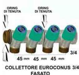
I collettori FASATI consente di assemblare più collettori senza l'ausilio di alcun sigillante, garantendo sempre l'allineamento delle uscite. Sono disponibili con valvole a vitone Sono utilizzabili per la realizzazione di impianti di riscaldamento, raffrescamento e sanitari.
