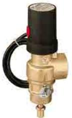
Valvola di scarico termico, ad azione positiva. Riarmo manuale per blocco bruciatore o allarme. P. d esercizio: 0,3 = P = 10 bar. Campo di temperatura: 5-100 °C. Temperatura di taratura 98 °C e 99 °C Certificata e tarata a banco INAIL (Ex ISPESL). Potenzialità scarico: 1"1/2X
