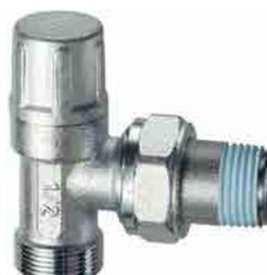
Detentore ad angolo. Attacco per tubo rame, plastica e multistrato. Cappuccio in ottone. Doppio O-ring di tenuta sull'asta Otturatore a battuta metallica e tenuta con O-ring. Codolo preguarnito.
