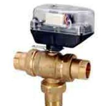
Valvola di zona a sfera deviatrice a passaggio totale a tre vie motorizzata con servocomando con relè e micro ausiliario per contatto pulito. Connessioni a bocchettone. Pressione max.d esercizio 16 bar. Pressione differenziale max. 10 bar. Temperatura
