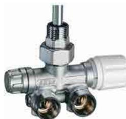
Valvola MONO-BITUBO termostaticabile sinistra a squadra, completa di codolo e calotta. Sonda metallica 450mm Ø 10mm. Attacchi intercambiabili per tubo rame, plastica e multistrato. Attacco centrale al corpo scaldante. Interasse derivazioni 35mm
