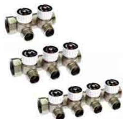
Collettore semplice assemblabile con di valvole di intercettazione. Attacchi da 3/4" o 1". Uscite laterali da 1/2 , interasse fra le uscite laterali 37,5 mm per il 3/4, e 50 mm per il 1". Targhette bifacciali blu-rossa e distribuzione sanitaria-riscaldamento incluse.
