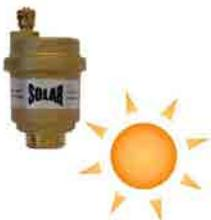
Valvola di sfogo aria per impianti solari Fluido d'impiego: Acqua e soluzioni glicolate Massima percentuale di glicole: 30% Temperatura max di esercizio: 130 °C Pressione massima di esercizio: 10 Bar Pressione massima di scarico: 2,5 Bar
