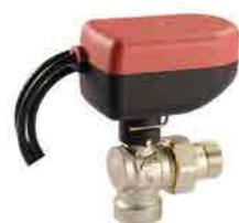
Valvola di zona a sfera ad ANGOLO con attuatore a sgancio rapido ,versione a 2 vie a 230 Volt (24 volt su richiesta) con fine corsa completa di contatto ausiliario pulito regolazione a 3 punti (spdt) o on/off (spst)
