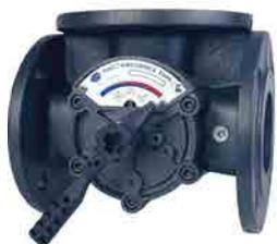
**VALVOLE MISCELATRICI SERIE 1000** Valvola miscelatrice a 3 vie: -Rotore interno a farfalla - Attacchi flangiati -Corpo e rotore in ghisa -Coperchio, bussola e maniglia in alluminio -Omologata ANCC
