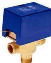
Valvola a tre vie M.M. azionate da un motorino elettrico e possono assumere due posizioni di funzionamento a seconda che quest'ultimo sia alimentato o no, due interruttori ausiliari azionati durante la commutazione della valvola. Dotate di una leva esterna per il posizionamento
