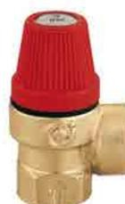
Valvola di sicurezza ordinaria, attacchi femmina. Sovrappressione di apertura 20 %. Scarto di chiusura 20 %. PN 10. Campo di temperatura: 5-110 °C. Tarature: 2,5 - 3 - 3,5 - 4 - 5 - 6 - 7 - 8 bar.
