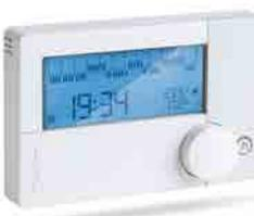
Cronotermostato digitale settimanale. Alimentazione 2 x 1,5 V AA. Durata batterie 3 anni. Portata contatti 5(1)A. Funzionamento On/Off. Caldo/Freddo Temperature impostabili 2 (com fort-ridotto). Intervallo regolazione 5-40°C. Antigelo regolabile 0.5°C - 25.0°C.
