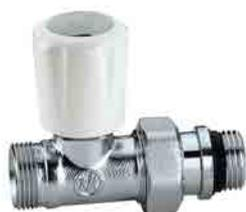
Valvola termostaticabile predisposta per comandi termostatici ed elettrotermici. Cromata. Attacchi diritti, per tubi in rame e plastica semplice e multistrato. Pmax d'esercizio: 10 bar. Campo di temperatura: 5-100 °C.
