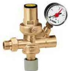
Gruppo di riempimento automatico, con rubinetto, filtro, valvola di non ritorno. Campo di regolazione: 0,3-4 bar. Pmax in entrata: 16 bar. Tmax d esercizio: 70 °C.
