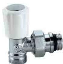
Valvola termostaticabile predisposta per comandi termostatici ed elettrotermici. Cromata. Attacchi a squadra, per tubi in rame e plastica semplice e multistrato. Pmax d'esercizio: 10 bar. Campo di temperatura: 5-100 °C.
