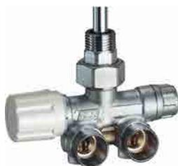
Valvola MONO-BITUBO termostaticabile destra a squadra, completa di codolo e calotta. Sonda metallica 450mm Ø 10mm. Attacchi intercambiabili per tubo rame, plastica e multistrato. Attacco centrale al corpo scaldante. Interasse derivazioni 35mm
