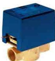
Valvola di zona con ritorno a molla, senza alimentazione elettrica la valvola è chiusa. Quando viene attivata l'alimentazione elettrica il servomotore vince la forza delle molle in circa 10 secondi e la mantiene in quella posizione sino a quando non si toglie l'alimentazione, le
