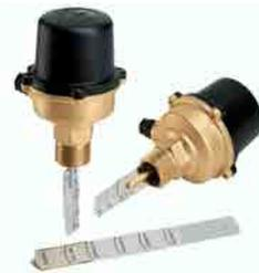
Flussostato. Per tubazioni da 1" a 8". attacco: G 1" A (ISO 228-1) M. Pressione massima di esercizio: 10 bar. Campo di temperatura del fluido: -30-120 °C. Grado di protezione: IP 54. Portata contatto (250 V): 15 (5) A.-
