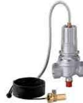
Valvola di intercettazione del combustibile. Corpo in alluminio. Attacchi filettati femmina. Pmax d esercizio: 50 kPa. Lunghezza capillare: 5 m. Certificata e tarata a banco INAIL (Ex ISPESL). Taratura 98 °C.
