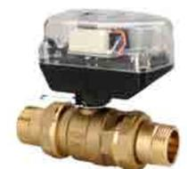
Valvola di zona a sfera a passaggio totale a due vie motorizzata con servocomando con relè e micro ausiliario per contatto pulito. Connessioni a bocchettone.Pressione max.d esercizio 16 bar. Pressione differenziale max. 10 bar. Temperatura
