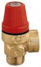
Valvola di sicurezza ordinaria certificata MF. Sovrappressione apertura 20%. Scarto di chiusura 20%.PN 10. Campo di temperatura: 5-110 °C. Tarature: 2,5-3-3,5-4-5-6-7-8 bar.
