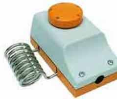
TERMOSTATO AMBIENTE PER SERRE-3 contatti Sonda esterna a dilatazione di liquido, contenitore stagno Grado di protezione: IP 54 Campo regolazione:  $+4^{\circ}\text{C} +40^{\circ}\text{C}$  ( $\pm 2^{\circ}\text{C}$ ) Relais libero da potenziale
