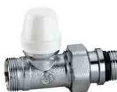
Detentore, attacchi diritti, per tubi in rame, plastica semplice e multistrato Cromato. Attacchi a squadra, per tubi in rame, plastica semplice e multistrato. Pmax d'esercizio: 10 bar. Campo di temperatura: 5-100 °C.
