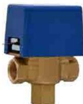
Valvola FFF a tre vie azionate da un motorino elettrico e possono assumere due posizioni di funzionamento a seconda che quest'ultimo sia alimentato o no, due interruttori ausiliari azionati durante la commutazione della valvola. Dotate di una leva esterna per il posizionamento
