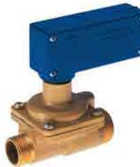
Flussostato SBP funziona come un pressostato sino ad un differenziale di pressione (?PB) secondo il quale si apre un by-pass che gli consente di funzionare come una valvola di sovrappressione. Al di sotto di questo valore (?PB), il flussostato SBP chiude, o devia, un contatto elettrico.
