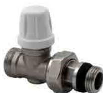
Detentore diritto per tubo di rame, Multistrato, Pe-X. Doppia tenuta sulla sede, o-ring più tenuta metallica. Corredato di bocchettone antigocciolamento.
