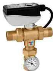
Miscelatore elettronico con disinfezione termica programmabile :1 valvola a sfera a 3 vie,-servocomando, regolatore,-sonda temperatura di mandata,-sonda temperatura di ritorno. Con microinterruttori ausiliari per gestione disinfezione ed altri apparecchi.
