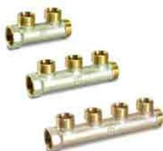
Collettore semplice in ottone nichelato uscita con attacchi EUROCONO da 3/4 che permette l'istallazione di tubazioni fino al diametro 20 multistrato e 18 in rame. Accessorio 289776 per una sede piana.
