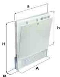
Cassetta per collettori Inoterm e Tempower, prodotta in acciaio, verniciata a caldo, provvista di cornice, supporti distanziali regolabili, porta anteriore con serratura. Spessore minimo 92 mm.
