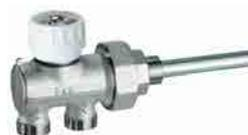
Valvola MONOSTILE MANUALE per impianti monotubo. Attacchi per tubo rame, plastica e multistrato. Sonda metallica 450mm Ø 12 o 14 mm. Interasse derivazioni 35mm
