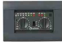
Centralina per la gestione del termocamino, installazione ad incasso alimentazione 230V, due manopole, una per l'impostazione della temperatura di riscaldamento e una per la sanitaria. La temperatura viene visualizzata tramite una barra al led, uscite per comandare una pompa di
