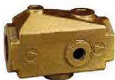
Separatore d'aria in GHISA permette di collegare diversi dispositivi per la regolazione ed il monitoraggio delle condizioni operative dell'impianto, come la valvola di sicurezza, il termomanometro, il vaso di espansione e la valvola sfogo aria.
