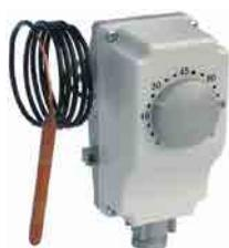
Termostato regolabile con capillare è impiegato soprattutto in impianti di riscaldamento per la regolazione di pompe, bruciatori, aerotermi e simili, campo 30 e 90 °C. Il capillare esterno all'involucro consente di poter prelevare la temperatura da monitorare
