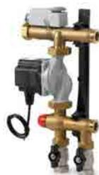
Sistema preassemblato di miscelazione, completo di valvola miscelatrice 3 vie, possibilità di comando termostatico o motorizzato; circolatore elettronico, termostato di sicurezza a contatto, valvola non ritorno nella sezione di ricircolo, pozzetto per sonda di mandata
