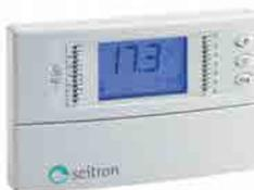
Freetime Plus cronotermostato giornaliero. La regolazione della temperatura attraverso i cavalieri. Alimentazione a batterie 2 x 1,5V AA. Durata batterie 1 anno. Programmazione giornaliera. Funzionamento On/Off. Caldo/Freddo 2 Temperature.
