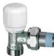
Valvola termostattizzabile a squadra cromata. Attacco per tubo rame, plastica e multistrato. Semplice sistema di estrazione volantino. Perno inox con doppio O-Ring di tenuta. Molla di richiamo rinforzata e otturatore piatto. Codolo preguarnito
