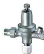
Gruppo di riempimento automatico Senza manometro per impianti a circuito chiuso completo di valvola di ritegno, rubinetto di arresto e filtro in ingresso. Attacco in entrata (bocchettone): 1/2 M Attacco in uscita: 1/2 F. Attacco manometro: 1/4 F.
