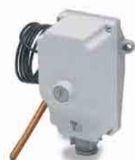
Termostato di sicurezza in custodia a capillare con sensore a dilatazione di liquido a regolazione interna a cacciavite con riarmo manuale a taratura fissa 110 °C con riarmo manuale Contatti in deviazione: C/NO/NC. Portata contatti 16(4)A 250Vca, 6(1)A 400Vca.
