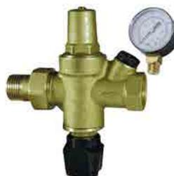
Gruppo di riempimento con manometro, rubinetto intercettazione e filtro. Attacco manometro da 1/4 su due lati. Completo di valvola di ritegno. Pressione max a monte 16 bar, pressione a valle regolabile da 1 a 6 bar, pressione di taratura a valle impostata 1,5 bar, temperatura max d'esercizio
