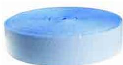
Giunto di dilatazione perimetrale in polietilene densità 23kg/m<sup>3</sup>, spessore di 8 mm altezza e 150 mm con film trasparente in PE-LD di spessore 50 µm termosaldato per evitare infiltrazioni di materiale cementizio tra il pannello ed il sottofondo con lato adesivo ad elevata
