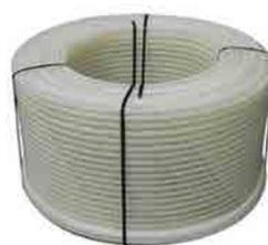
Tubo a 5 strati in polietilene stabilizzato per alte temperature, prodotto in conformità a SKZ HR 3.16 lo strato centrale è costituito da una barriera all'ossigeno EVOH.
