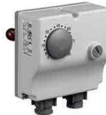
Bitermostato impiegato soprattutto negli impianti di riscaldamento. La regolazione viene usata per il comando di pompe, bruciatori, aerotermi e simili, termostato di sicurezza a riarmo manuale per l'arresto in caso di sovratemperatura.
