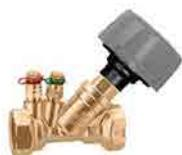
Valvola di bilanciamento per circuiti idraulici. Corpo in lega antidezincificazione, otturatore in acciaio inox. Complete di prese di pressione ad innesto. Pmax d esercizio: 16 bar. Campo di temperatura: -20-120 °C. Max percentuale di glicole: 50 %.
