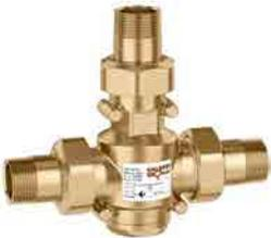
Valvola anticondensa per generatori a combustibile solido, glicole Max 50%. Pmax di esercizio: 10 bar. Campo di temperatura: 5-100°C Tarature (Tset): 45°C, 55°C, 60°C, 70°C. Precisione taratura: ± 2°C Temperatura di chiusura completa by-pass: Tmin = Tset +10 °C = Tr.
