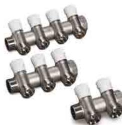
Collettore con valvole di arresto in ottone nichelato uscita con attacchi EUROCONO da 3/4 che permette l'istallazione di tubazioni fino al diametro 20 multistrato e 18 in rame. Accessorio 289776 per una sede piana.
