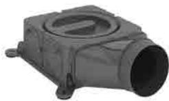
Box di distribuzione per impianti di VMC in Polipropilene e master antibatterici che consente l'abbattimento di cariche batteriche all'interno del sistema di ventilazione meccanica. Il box è dotato di 18 connessioni chiuse, apribili a seconda delle necessità
