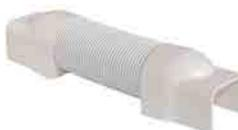
Manicotto flessibile, permette di aggirare eventuali ostacoli (grondaie, travi, etc.) e di risolvere tutte le situazioni più complicate di installazione. Lunghezza min 200 mm/max 700 mm.
