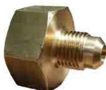
Raccordo femmina per bombole con valvola filetto W21,7-1/14 RH (destra) - uscita 1/4 SAE RH (destra) per R134a, R22, R404A, R407C, R407F ecc.
