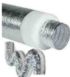
Condotto aria flessibile con tessuto spalmato di resine poliolefiniche e spirale in filo di acciaio armonico. Rivestimento termoisolante di poliestere (sp. 25mm/16kg/m3). Protezione esterna antivapore. REAZIONE AL FUOCO: CLASSE IT: Classe 1
