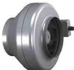
Ventilatori centrifughi in linea, realizzati in lamiera verniciata, girante in acciaio zincato. Motore elettrico direttamente accoppiato è raffreddato direttamente dal fluido convogliato, lavora in qualsiasi posizione. Entrambi i lati del ventilatore sono predisposti per la connessione ai condotti.
