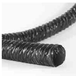
Condotto flessibile in tessuto poliestere con resine poliolefiniche additate e spirale in filo di acciaio armonico. verga compressa da 10 m, da 80 a 610 mm Temp. -20°C /+90° (+110°C punte) REAZIONE AL FUOCO: CLASSE IT: Classe 1
