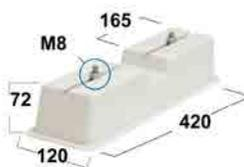
**COPPIA** Base a pavimento in materiale plastico antiurto e resistente ai raggi UV, dotata di viti e bulloni per il fissaggio all'unità esterna e di fasce adesive per un buon adattamento al pavimento. L=420 peso massimo per kit Kg. 320
