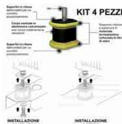
Antivibrante con supporto in materiale termoplastico rinforzato, resiste all'invecchiamento atmosferico, ai raggi UV ed alle temperature da -50°C a +120°C. Il Kit è composto da: n. 4 antivibranti Vite/Dado; viteria per il montaggio su staffa e/o a terra.
