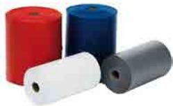
Rotolo in PVC elastico non adesivo utilizzabili per rivestimento esterno, protezione di tubi interrati e manufatti. Caratteristiche tecniche: Materiale PVC: vinilico T.E. max: 65°C H: 100 mm Spessore: 0,1 mm Rotolo da 25 metri.
