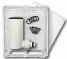
SIFONE MECCANICO A SECCO ISPEZIONABILE MINI II. Colonna di chiusura idraulica da 50 mm Raccordo superiore di entrata acqua in gomma Componenti interni smontabili, sifone realizzato con uscita a 90°. Montaggio reversibile dx e sx, sia con scatola da incasso a muro Portata 60 l/h
