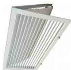
Griglia di ripresa porta-filtro in alluminio, colore bianco, ad alette fisse inclinate a 45°. Filtro piano intelaiato (spessore 10 mm, efficienza G3) incluso.
