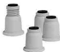
Supporti in materiale termoplastico rinforzato con fibra di vetro, regolabili in altezza da un minimo di 100 mm fino ad un massimo di 130 mm. Completo di guarnizione o-ring in NBR per evitare lo scivolamento. Optional: Chiave per regolarne l'altezza.
