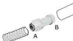
Raccordo per collegare il tubo scarmico condensa spiraleto con tubo rogido
