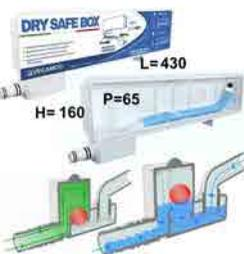
Vaschetta per la predisposizione clim atizzatori dimensioni 430X160X50 uscita reversibile Raccordo per attacco tubo d. 16/18 e d. 18/20 m m valvola a gravità che evita il ristagno e cattivi odori.
