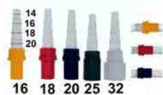
Giunzioni per raccordare tubo rigido e tubo flessibile di scarico condensa. Sono adatti per raccordare i tubi di uscita dell'acqua di condensa dell'evaporatore interno al tubo rigido o flessibile di misura diversa. Tubi di Ø 14-16-18-20.
