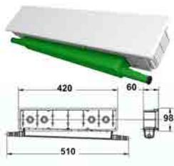
**WALLBOX** - Cassetta lunga 42 cm predisposizione da incasso per attacco climatizzatore per la raccolta condensa dell'apparecchio di condizionamento Doppio attacco per il tubo di scarico
