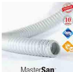
Condotto aria, antibatterico e antimuffa. Rivestimento termoisolante in polietilene reticolato espanso, esterno con film di resine poliolefiniche. Spirale in filo di acciaio armonico temp. -20 + 90° velocità aria massimo 20 mt/sec. pressione massima 200 mm H2O
