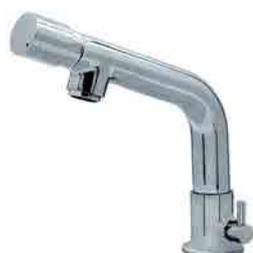
Miscelatore lavabo a pulsante, temperatura regolabile dalla levetta laterale, portata regolabile da 2 a 10 lt./m tempo di apertura circa 20 sec. regolabile, cartuccia in ottone inox, 2 flessibili inox, foratura 30 mm. Spessore massimo del piano mm. 40
