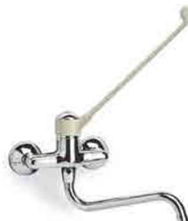
Monocomando con cartuccia in dischi ceramici bocca orientabile Ø 20 maniglia a leva antiurto 283 indeformabile in termopolimero rosetta Ø 70 portata a 3 bar 26 litri/minuto LUNGHEZZA BOCCA 200 mm
