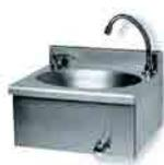
Lavamani ovale 304 distributore antivandalo di sapone liquido chiave a brugola per il riempimento dall'alto capacità serbatoio lt. 1 rubinetto a ginocchio temporizzato erogazione per circa 10 sec. bocca di erogazione orientabile R 590 A7, riduttore 7 l/m
