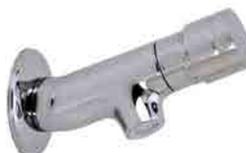
Rubinetto a parete con portata regolabile fino ad un consumo minimo di 4 litri/minuto, tempo di apertura di circa 20 secondi regolabile chiave in dotazione, cartuccia in ottone. Corpo inclinato per facilitare il movimento della mano per l'apertura
