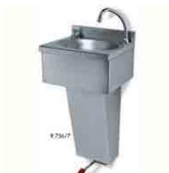
Comando a pedale conforme sistema HACCP lavamani ovale in acciaio inox AISI 304 con colonna, completo di distributore antivandalo di sapone liquido, rubinetto a pedale collegato alla bocca di erogazione orientabile con riduttore automatico di 7 litri/minuto
