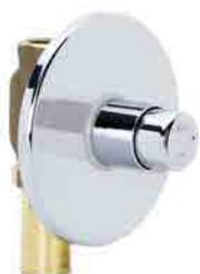
Flussometro da incasso dispositivo antisifonico incorporato piastra regolabile ottone lucidato e cromato Ø 137 tempo di apertura regolabile da 0 a 12 sec. con la chiave in dotazione portata 1,2 l/sec. in dotazione protezione per le opere di muratura
