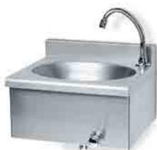
Comando a ginocchio conforme sistema HACCP lavamani ovale in acciaio inox AISI 304 miscelatore a ginocchio temporizzato erogazione per circa 10 sec. riduttore automatico 7 litri/minuto .conforme HACCP
