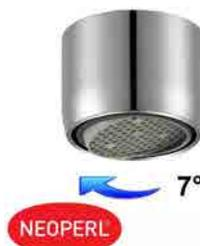
Perlatore che fa risparmiare fino al 50 % di acqua Regolazione della direzione del getto d'acqua angolo di orientamento  $\pm 7^\circ$  con compatibilità totale Non adatto a dispositivi non in pressione Classe di portata Z 7,5-9,0 l/m a 3 bar
