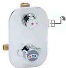
Miscelatore da incasso meccanico e anticalcare per doccia comando a pulsante piastra regolabile 120x190 mm. in ottone, completo di codoli con valvole di non ritorno e fitri inox. Tempo di apertura regolabile con la chiave in dotazione da 0 a circa 50 secondi, 9 l/m
