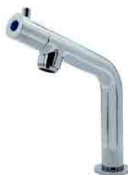
Rubinetto lavabo con maniglia in ottone segnalino blu, vitone a dischi ceramici portata circa 16 l/min, kit di fissaggio, foratura D.30 mm. spessore massimo del piano mm. 30.
