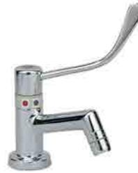
Miscelatore antiscottatura per lavabo solo rotazione orizzontale della leva a gomito per ottenere acqua fredda e progressivamente acqua miscelata e calda taratura fissa 7 litri/minuto incorporato filetto 1/2
