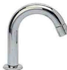
Bocca fissa Ø 28 alta antivandalo per lavabo in dotazione chiave a brugola per la manutenzione aeratore antivandalo con riduttore di portata a taratura fissa 7 litri/m minuto incorporato attacco Ø 3/4 ridotto 1/2 maschio
