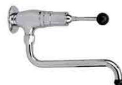
Rubinetto a parete comando a leva, con il semplice tocco in tutte le direzioni si ottiene l'erogazione per circa 20 sec. dispositivo automatico di portata per una erogazione costante di 7 litri/minuto. Bocca di erogazione orientabile Ø 16, lunghezza mm. 180
