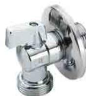
Rubinerro a sfera ad angolo per lavatrice o lavastoviglie, rosone in acciaio Inox, leva metallo nichelato corpo in ottone CW617N, tenuta Asta: NBR . Tenuta Sfera: PTFE. Sfera: Ottone CW617N
