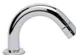
Bocca fissa bassa per lavabo in dotazione chiave a brugola per la manutenzione ottone lucidato e cromato Ø 28 aeratore antivandalo con riduttore di portata a taratura fissa 7 litri/m minuto incorporato attacco Ø 3/4 ridotto 1/2 maschio
