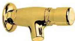
Rubinetto a parete comando a pulsante cartuccia in ottone e con dispositivo automatico di portata di 7 litri/minuto da 0,5 a 9 bar ottone GIALLO completo di rosetta mm. 56 erogazione circa 20 sec.
