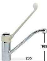
Monocomando con cartuccia in di schi ceramici corpo rialzato in ottone lucidato e cromato bocca orientabile maniglia a leva LUX DUE in dotazione flessibili inox portata a 3 bar 26 l/m foratura mm 33
