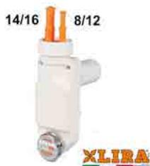
Sifone salvaspazio ispezionabile dotato di doppio attacco per lo scarico di Caldaie a condensazione, Climatizzatori, deumidificatori, asciugatrici Ø8-12-14-16 Lavatrici o lavastoviglie Ø20-25 Completo di TEE
