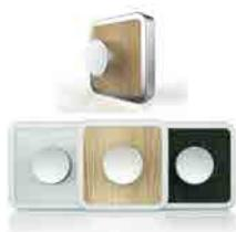
Cartuccia di ripristino meccanico tipo Catís con rosone quadro, permette il rinnovo del pulsante pneumatico, svitando la borchia esistente e la relativa molla, si estrae il sistema e si sostituisce con il nuovo, senza ricorrere ad opere murarie
