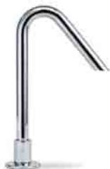
Bocca di erogazione fissa senza rompigetto per lavamani in ottone lucidato e cromato attacco 1/2 con rosetta D. 50 foratura mm. 21 con riduttore di portata di 7 litri/minuto facilmente ispezionabile
