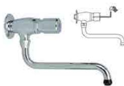
Rubinetto a parete con tempo di apertura regolabile con la chiave in dotazione da 0 a 30 secondi, 7 litri/minuto con segnalino blu e rosso per la maniglia. Bocca di erogazione orientabile Ø 16, lunghezza mm. 180
