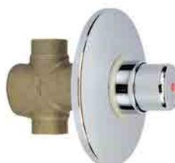
rubinetto incasso per orinatoio Ø 1/2 co mando a pulsante completo di piastra regolabile in ottone Ø 117 con dispositivo automatico di portata per una erogazione costante di 7 litri/m inuto da 0,5 a 9 bar, erogazione per circa 6 secondi.
