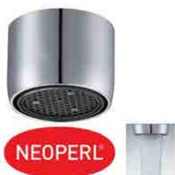
PERLATORE protezione anticalcare grazie alla struttura HONEYCOMB protezione antivandalismo: la struttura HONEYCOMB non può essere spinta all'interno. Non adatto a dispositivi non in pressione Classi di portata A-13,5-15,0 l/m a 3 bar
