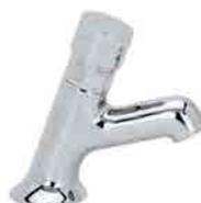
Rubinetto lavabo con portata regolabile fino ad un consumo minimo di 4 litri/minuto, tempo di apertura di circa 20 secondi regolabile con la chiave in dotazione cartuccia in ottone con spillo inox
