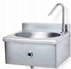
Lavamani trapezoidale in acciaio inox 304 comando elettronico con miscelatore collegato alla bocca di erogazione orientabile R 590A7 con riduttore 7 litri/minuto piletta inox Ø 1"1/2 supporto inox per il fissaggio a parete tasselli e viti.
