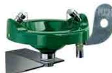
Lavaocchi con supporto ACCIAIO INOX per il montaggio a parete, con riduttore automatico di portata - apertura a spinta - portata 12 litri/m in. vaschetta lavaocchi ABS VERDE PUSH in alluminio pressofuso
