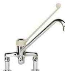
Monocomando biforo con cartuccia in dischi ceramici, corpo, supporto e bocca in ottone fuso cromato, bocca Ø 20, maniglia a leva 283 antiurto in tecnopolimero foratura mm 22 per 1/2 foratura mm 27 per 3/4 interasse portata 26 l/m bocca 245 mm.
