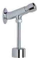
rubinetto a squadra Ø 1/2 per orinatoio comando a pulsante completo di rosetta mm. 56, erogazione costante di 7 li tri/minuto da 0,5 a 9 bar, erogazione per circa 6 secondi. In dotazione tubetto di scarico mm. 250, dado e campana.
