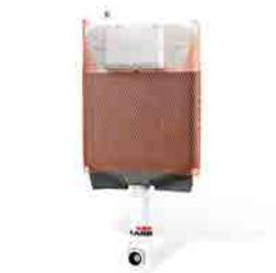
Cassetta incasso per WC , con rubinetto d arresto, tubo di scarico regolabile fino a 100mm con copertura in polistirolo e guarnizione conica, dima per piastrellatura/protezione cantiere, tubo di cacciata, galleggiante "Norma-Plus" regolabile tra 9 e 6lt
