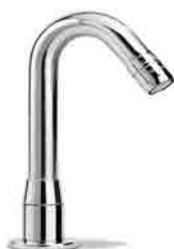
Bocca di erogazione fissa per lavabo Ø 22 ottone lucidato e cromato con riduttore di portata a taratura fissa 7 litri/minuto attacco Ø 3/4 ridotto 1/2 maschio
