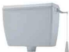
Cassetta installazione esterna posizione alta, completa di corda Scarico a tirare Scocca con trattamento anti-invecchiamento Capacità 8 litri. Allacciamento idrico destro o sinistro Galleggiante 3/8" compatto, TUBO SCARICO DA ORDINARE
