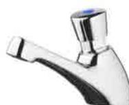
Rubinetto monoacqua temporizzato 8-12 secondi per lavabo, comando a pulsante, Installazione sopra piano connessione gambo filettato G 1/2, sistema antivandalo
