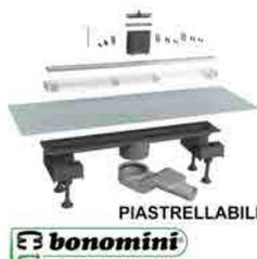
canalina con scarico centrale, griglia piastrellabile e regolabile "MIXAGE" con telaio in ABS e griglia in acciaio inox AISI316, telo impermeabilizzante e sifone "SOGLIOLA" uscita 50
