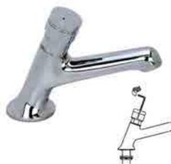
Rubinetto lavabo con portata regolabile fino ad un consumo minimo di 4 litri/minuto, tempo di apertura di circa 20 secondi regolabile con la chiave in dotazione cartuccia in ottone con spillo inox foratura mm. 22, spessore max del piano mm. 25
