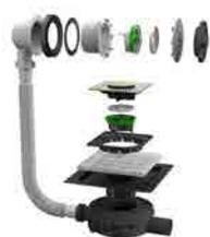
Scarico per vasche in muratura con griglia 150 X 150 meccanismo di chiusura a scatto, predisposto per l'impermeabilizzazione sotto-mattone e troppopieno cromato. Scarico ø 50 mm. In ABS
