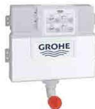
Cassetta incasso sottofinestra, altezza di installazione 820 mm per sottofinestra, con 2 volumi di sciacquo, pneumatico azionamento frontale o dall'alto raccordo di entrata da sinistra/destra o dall'alto, 415X410X360 mm
