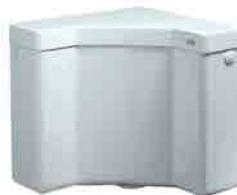
Cassetta per installazione esterna Installazione ad angolo, tasto economizzatore d'acqua start/stop Scocca con trattamento anti-invecchiamento Capacità 8 litri. Coibentazione anti-condensa insonorizzante Galleggiante 3/8" compatto.
