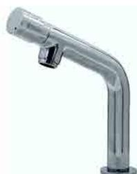
Rubinetto lavabo comando a pulsante, portata regolabile da 2 a 10 litri/minuto, tempo di apertura circa 20 sec. regolabile con la chiave in dotazione, cartuccia in ottone con spillo inox, foratura D.30 mm. Spessore massimo del piano mm. 30
