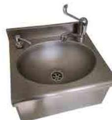
Lavamani ovale in acciaio inox AISI 304 completo di distributore antivandalo di sapone liquido con pompa interamente in ottone miscelatore monocomando con dischi ceramici e bocca di erogazione orientabile
