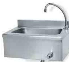
Lavamani trapezoidale in acciaio inox AISI 304 comando a ginocchio temporizzato erogazione per circa 10 sec. collegato alla bocca di erogazione orientabile 800 00 A7 con riduttore 7 litri/minuto conforme HACCP
