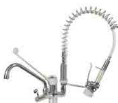
SET lavastoviglie monocomando rotazione a 180°, corpo rialzato, rubinetto deviatore con dischi ceramici rotazione a 90°, bocca orientabile, regolazione dell'altezza della doccia, flessibili inox, valvole di non ritorno. Foratura mm. 33, portata 26 litri/minuto
