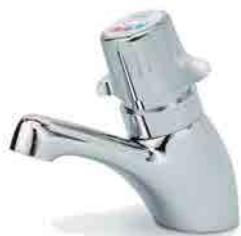
Miscelatore lavabo monocomando a pulsante erogazione per circa 20 secondi, portata costante di 10 litri/m minuto. Valvole di non ritorno Ø 3/8 per il montaggio sull'uscita di tutti i rubinetti a maglia in ABS cromato, temperature regolabile anticottatura
