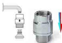
Riduttore automatico a taratura fissa di 5, 7, 9 litri/m inuto indipendentemente dalla pressione di esercizio da 0,5 a 9 bar spositivo di taratura in hostaform ispezionabile per eventuale pulitura.
