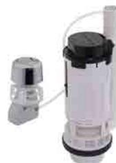
Valvola di scarico universale a doppio pulsante per cassette monoblocco in ceramica, azionamento a cavo montaggio alto, laterale o frontale adattabile, uscita scarico 60 mm. Incastro e sgancio automatico del pulsante, regolazione di volumi di scarico
