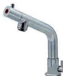
Miscelatore lavabo, maniglia in ottone segnalino rosso temperatura dalla levetta laterale, vitone a dischi ceramici, in dotazione 2 flessibili inox, 2 valvole di non-ritorno, portata circa 10 l/m, foratura d.30 mm. Spessore massimo del piano mm. 40.
