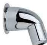
Braccio doccia antivandalo e anticalcare in ottone con soffione incorporato, uscita getto d'acqua da un solo foro turbina in hostaform, riduttore di portata di 9 l/m da 0,5 a 9 bar il braccio doccia installato a 2 mt. di altezza ha una rosa di 70 cm.
