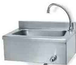
Lavamani trapezoidale inox AISI 304 completo di distributore antivandalo di sapone liquido con pompa interamente in ottone riempimento dall'alto miscelatore a ginocchio temporizzato erogazione circa 10 sec. riduttore 7 litri/minuto conforme HACCP
